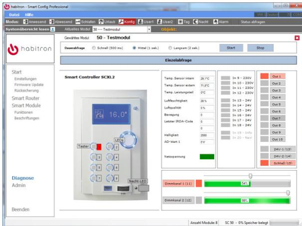
Die Smart-Config ist eine sehr einfach zu bedienende Konfigurationssoftware für das habitron-System. Mit dieser Software lässt sich das System leicht konfigurieren, anpassen und erweitern.
